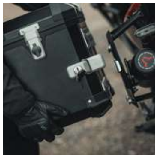
Las maletas laterales se encajan con facilidad en las cuatro levas de sujeción del soporte.
