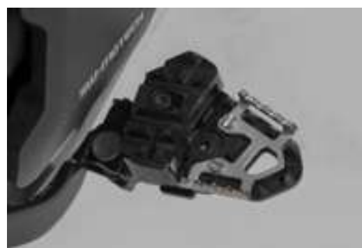
Extensión de la superficie de apoyo para el pie
