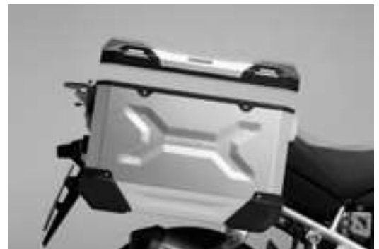
La tapa se puede abrir por un lado o extraer por completo
