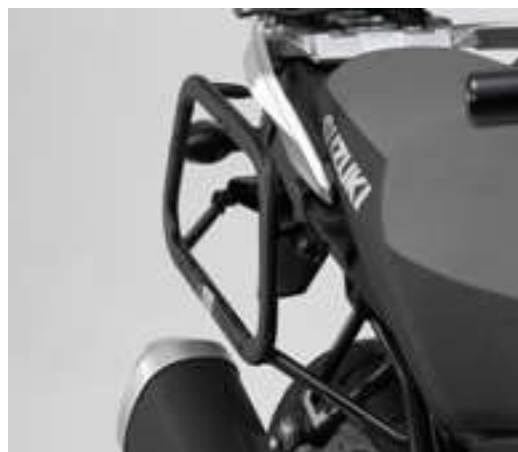
Tubo de acero ovalado, diseño ceñido al vehículo
