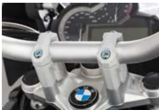
Fabricado a partir de una aleación de aluminio de alta calidad
