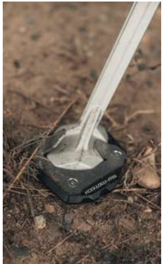
Mayor soporte y superficie de apoyo en terrenos irregulares.
